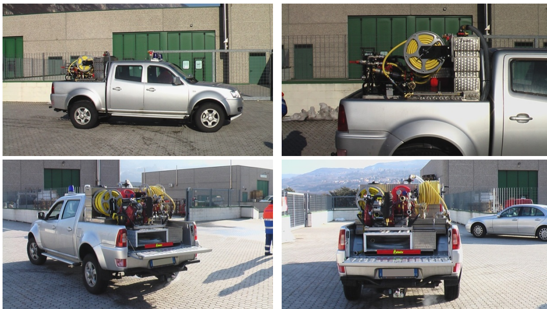
Esempio di mezzo tipo SM1 – Modulo scarrabile su pick-up (preparato da ditta specializzata)
