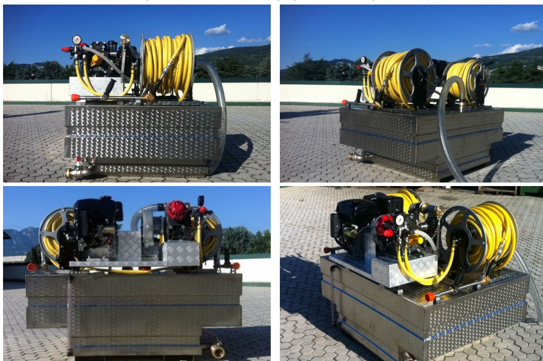
Esempio di modulo antincendio (preparato da ditta specializzata)
