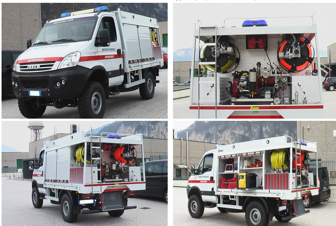
Esempio di mezzo tipo SM2 - Autobotte leggera (preparato da ditta specializzata)
