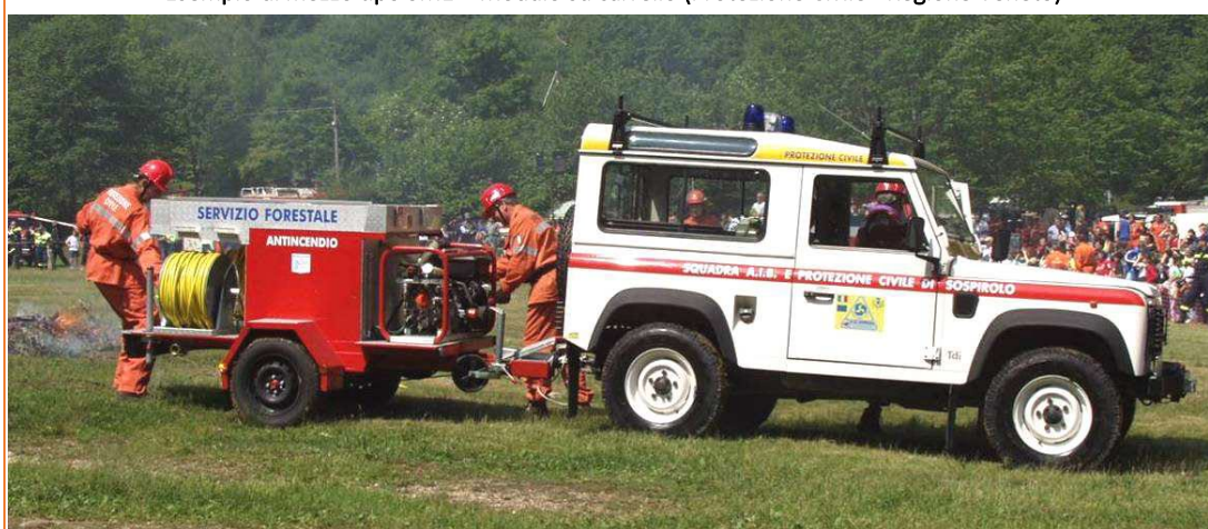
Esempio di mezzo tipo SM1 – Modulo su carrello (Protezione Civile - Regione Veneto)
